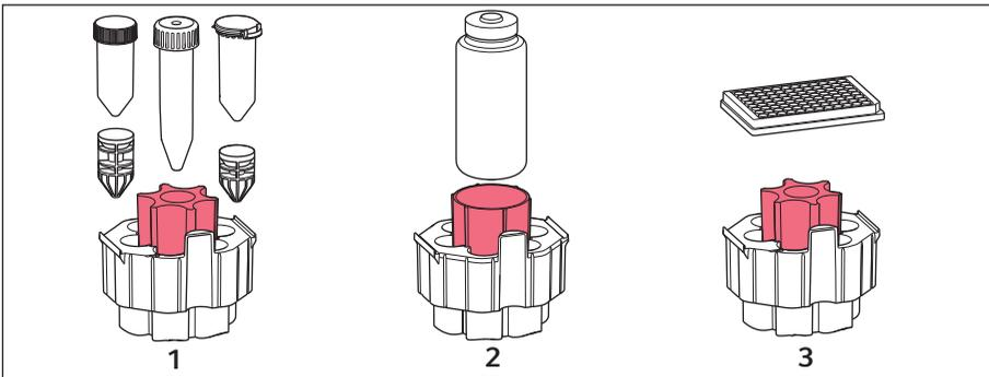
**3.1.1 Rotor S-4xUniversal for the Centrifuge 5910R and Centrifuge 5910Ri**
